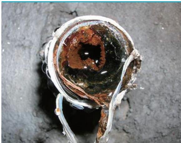
Das Rohr ist fast mit der Skala verstopft.
